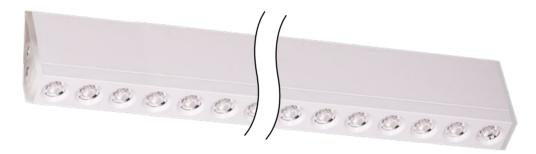
Corpo: alluminio estruso Fissaggio: a clip Montaggio: a plafone Ottica: lenti 25° / 40° / 60° / 80° Cavo di alimentazione: incluso 20 cm FROR antifiamma 2 poli (2x0.5 mm) Alimentazione: tensione 24 Vdc Potenza massima assorbita: 10 W/mt Temperatura di utilizzo: -30°C + +50°C Peso: 360 gr/28cm Normativa: prodotti in conformità alle vigenti norme Europee
